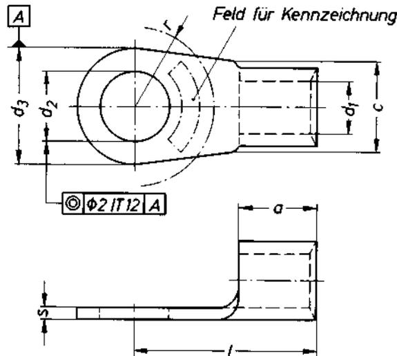
Bezeichnung eines Kabelschuhes von Nenngröße 6 – 16:
